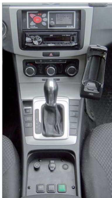
Mittelkonsole m. Bedienteil SSA, Radio, Ladehalterung Tetra, Sendetaste u. Lautstärkereger, Schalter Eigensicherung u.a.
